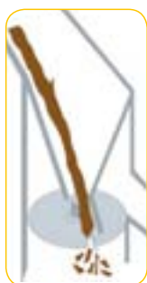
Větve jsou postupně odkrajovány dvěma noži umístěnými na rotujícím talíři s vysokými otáčkami.
