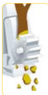
Materiál je drcen mezi pomaluběžným ozubeným kolem a přítlačnou deskou.
