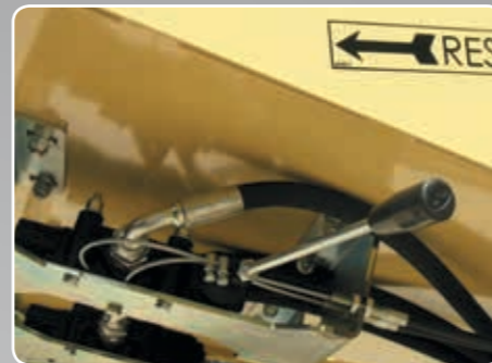
Sistema di sblocco emergenza di introduzione Reset system to release emergency stop Système de remise pour débloquer l'arrêt de sécurité Sistema de desbloqueo para de emergencia insertado Wiederzuschaltung der Einzugswalze nach dem Notstop Systeem om de noodstop weer vrij te maken Система разблокировки в случае аварийной ситуации при введении материала
