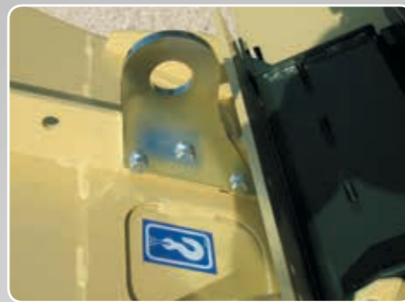
Ganci di sollevamento Lifting hooks Crochets d'élévation Enganches para el levantamiento Aushebehaken Optil haken Крюки для поднятия
