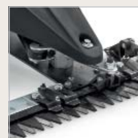
UNIVERZÁLNÍ ŽACÍ LIŠTA SE ČTYŘMI VODICÍMI DESKAMI
