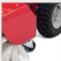
VELICE STABILNÍ OPĚRNÁ KOLEČKA S JEDINEČNOU FUNKCÍ KARTÁČE PRO POHYB VZAD
