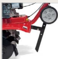
VE ZVEDNUTÉ POLOZE (V PRACOVNÍ POZICI) SLOUŽÍ ZÁVĚS KOLA JAKO VÝŠKOVĚ NASTAVITELNÁ KYPŘÍČÍ OSTRUHA, JEN U MODELŮ T/205 A T/245
