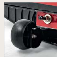
KOLEČKA ŽACÍHO ÚSTROJÍ ANTI-SCALP
