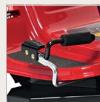
U VYBRANÝCH MODELŮ HYDROSTATICKÝ POHON
