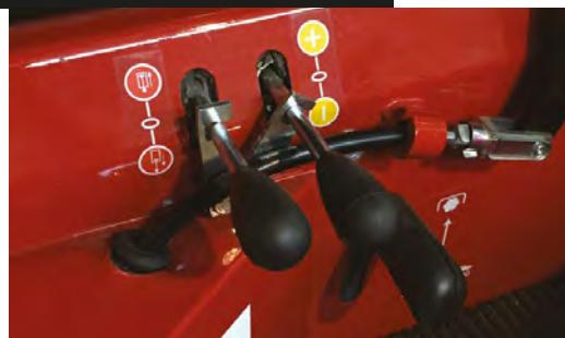
Hydraulický rozvaděč se 2 dálkovými pákami a 3 vývody vzadu za sedadlem.
