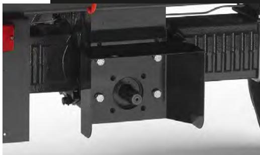
Zadní standardní PTO a centrální PTO s nezávislou hydraulickou spojkou.
