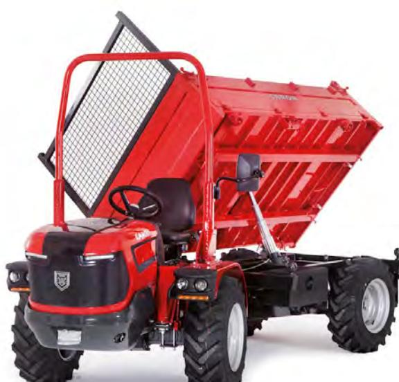
3-stranná využitelná hydraulicky ovládaná korba s trubkovými boky a automatickým otevíráním zadní strany.
