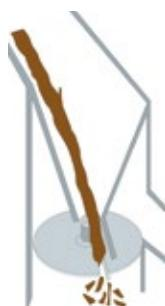
Větve jsou postupně odkrajovány dvěma noži umístěnými na rotujícím talíři s vysokými otáčkami.
