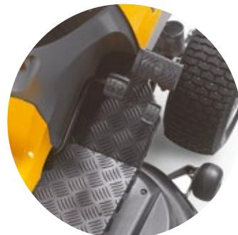
Všechny traktory STIGA (s výjimkou traktoru Estate 384 M) mají hydrostatickou převodovku. Jednoduchým seslápnutím pedálu plynule měněte pojezdovou rychlosť vpřed nebo vzad.
