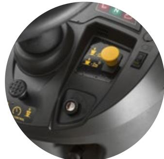
Traktory řady Estate a Tornado mají elektromagnetické zapínání sečení. Jedním tlačítkem snadno zapnete nebo vypnete sečení.
