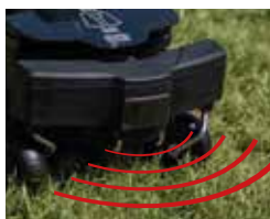
RADAR pro detekci překážek RADAR for obstacle detection
